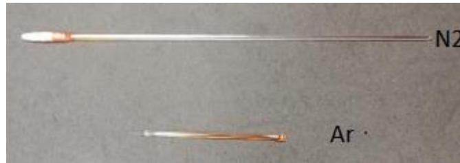
Figura 9. Rubís crecidos por fusión zonal en diferentes atmosferas.
