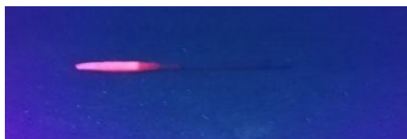
Figura 12. Rubí crecido por fusión zonal en atmosfera de aire iluminado con luz ultravioleta.
