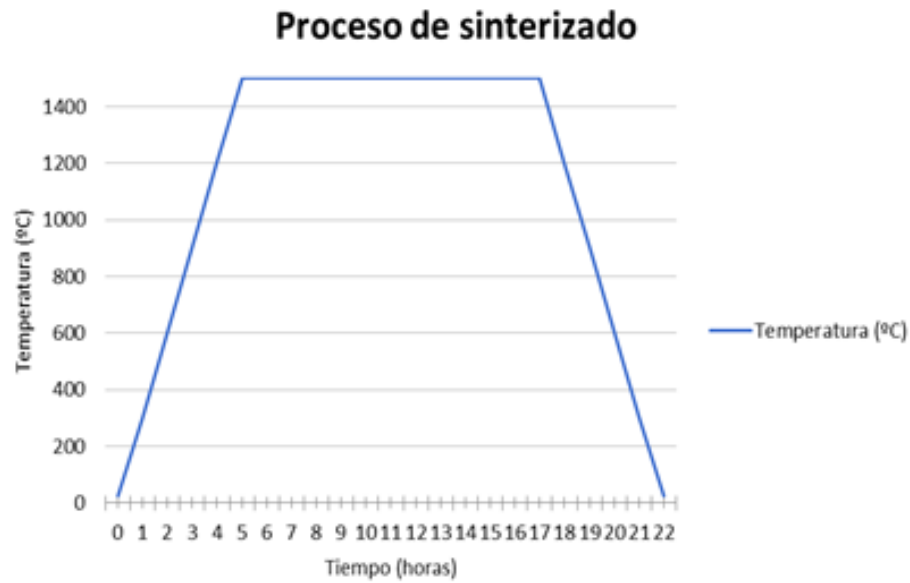
Figura 2. Gráfica representativa del proceso de sinterizado.
