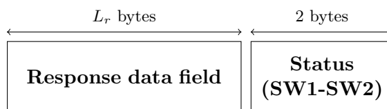
Figura 2.3: Respuesta de un comando APDU
