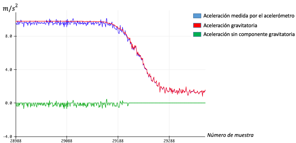
Gráfica 3. Aceleración en el eje Z tras una rotación sobre el eje X
