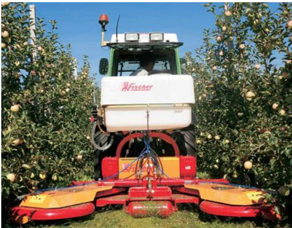
Ilustración 24: Segadora dos inter-cepas trabajando
