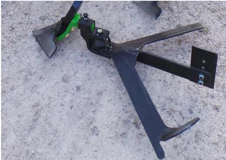
Ilustración 20:Apero con Inter-cepas mecánico
