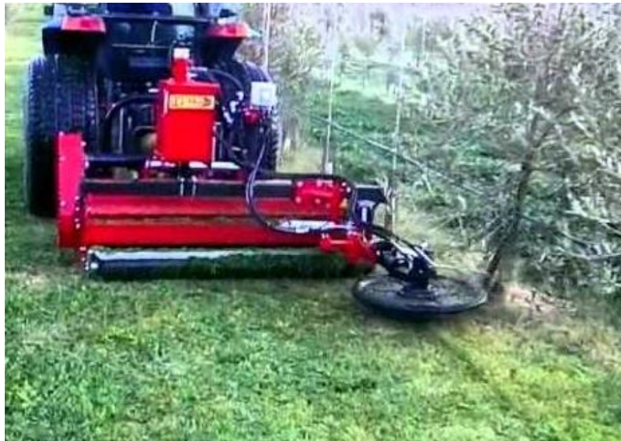
Ilustración 22: Trituradora con un inter-cepas
