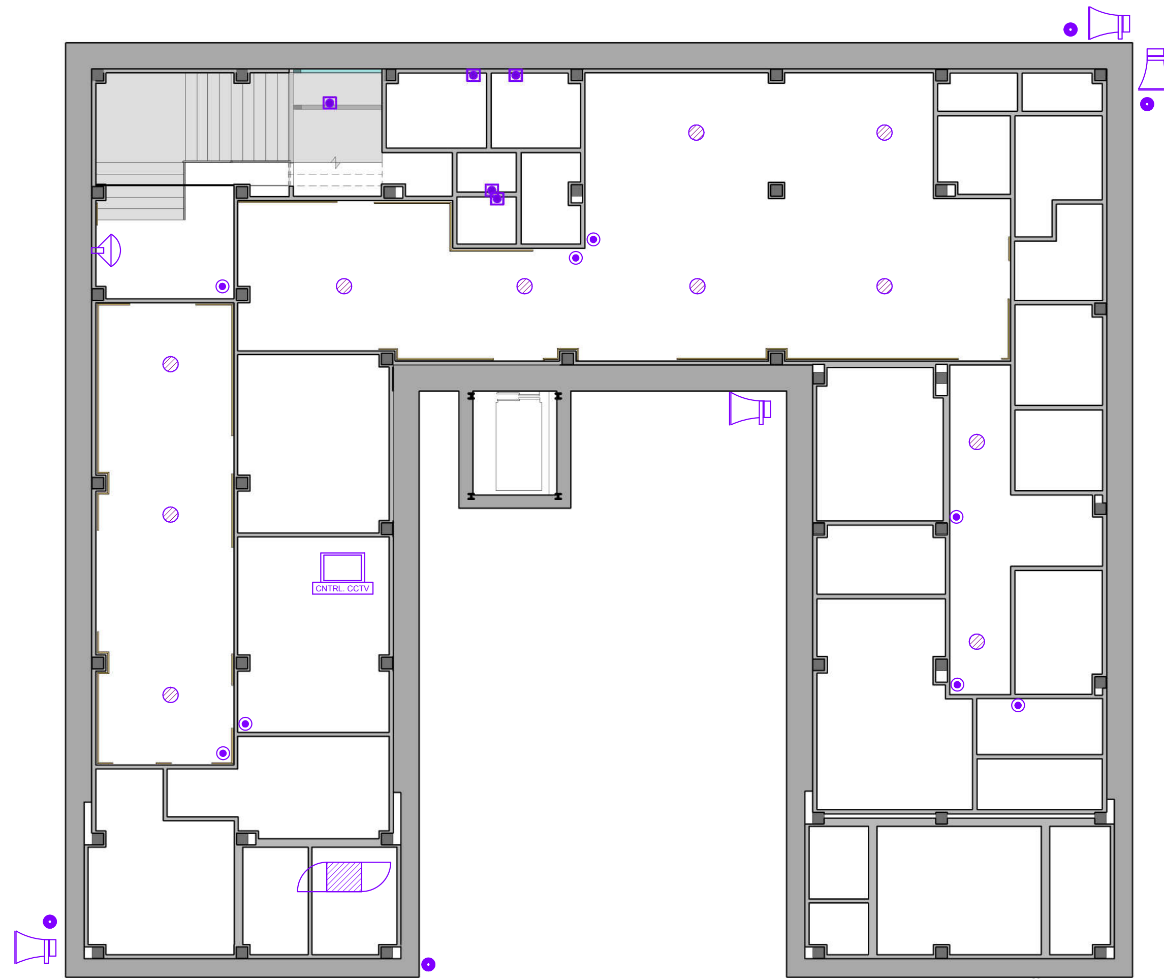
1 ER27 TE 00 Planta Baja Seguridad-Megafonia
