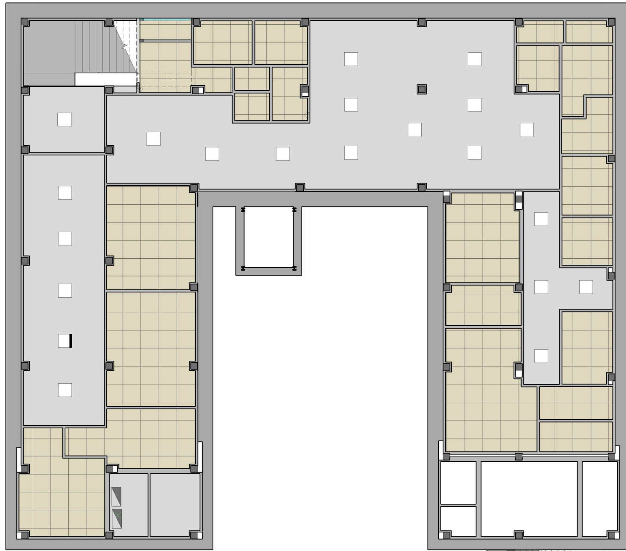
AR_09 Planta Baja Falsos techos
