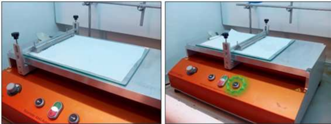
Figura 7. Proceso de Casting del soporte P84 mediante “doctor blade”
