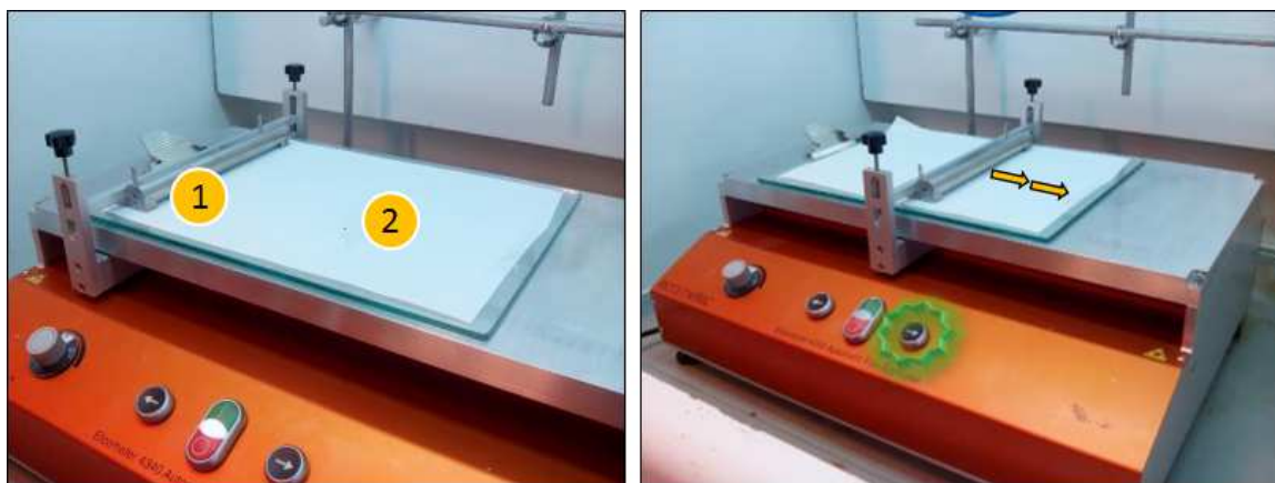
Figura 1. Proceso de Casting del soporte P84 mediante “doctor blade”: 1- Cuchilla 250 de \mu\text{m} que barre el largo de la placa de vidrio y distribuye la disolución, 2. Soporte de polipropileno sobre la placa de vidrio.
