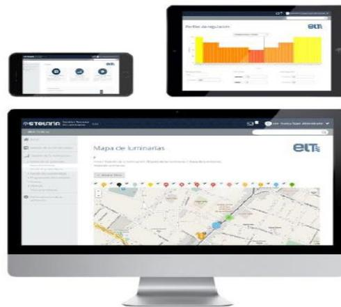
Figura 77 Software de monitorización y gestión. Interfaz Web multi-dispositivo
