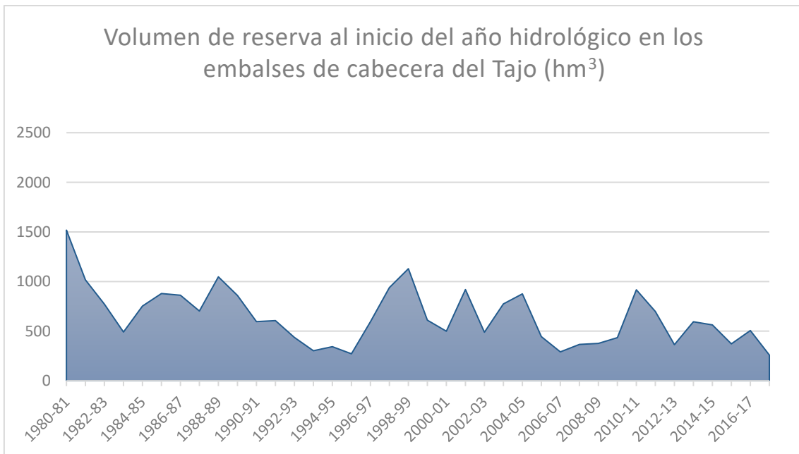
Gráfico 63.- Volumen de reserva al inicio del año hidrológico en los embalses de cabecera del Tajo con la regla de explotación del RD 773/2014. Elaboración propia.
