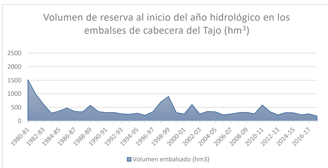
Gráfico 72.- Volumen de reserva al inicio del año hidrológico en los embalses de Entrepeñas y Buendía cuando el trasvase funciona a su máxima capacidad. Elaboración propia.
