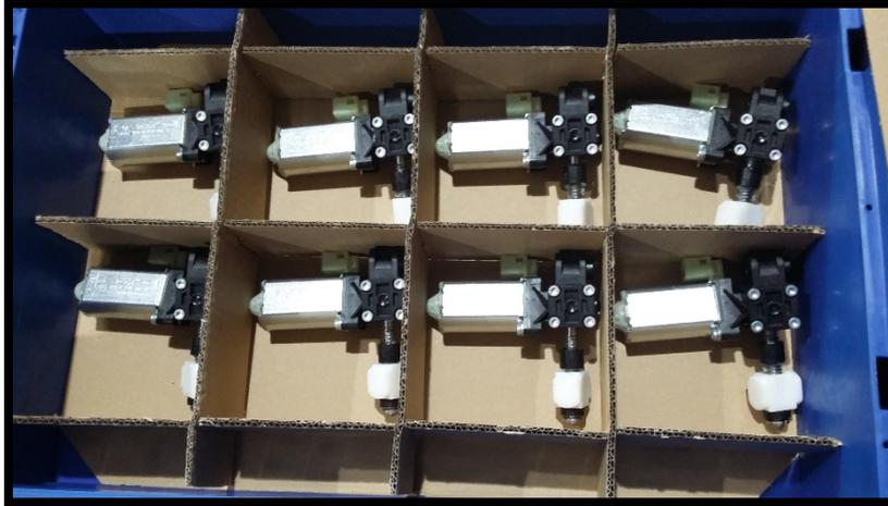
*Imagen 14 Servomotores*
