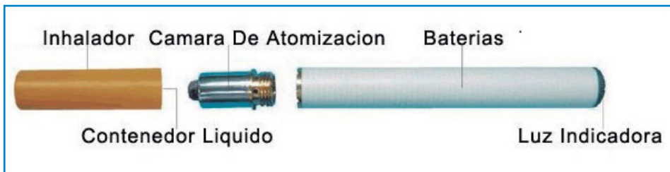
Figura 1. Partes de un cigarrillo electrónico.
