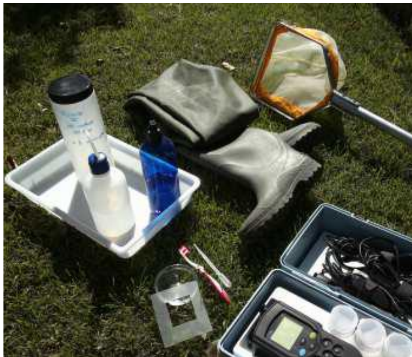
Figura 12: Arriba; bandeja, frasco de plástico, agua destilada, etanol (70 %), vadeador y red surber. Abajo; material para muestreo de perifiton: frasco de cristal, cepillo, pipeta y molde de plástico (5 x 5 cm).
