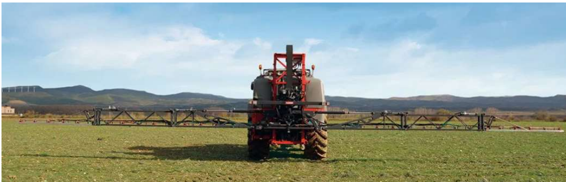
Figura 8: barras de un pulverizador del catálogo del fabricante de 18m similar al de 26m que se presenta en este trabajo
