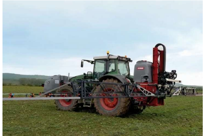
Figura 3: barras de 18m completamente extendidas, en la posición de trabajo, del mismo fabricante que las de 26 metros que se presentan en este trabajo.
