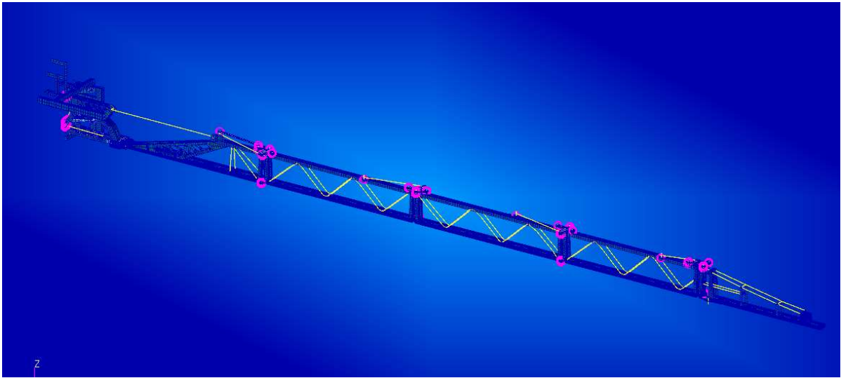
Figura 12: modelo discretizado de la estructura de barras de un pulverizador
