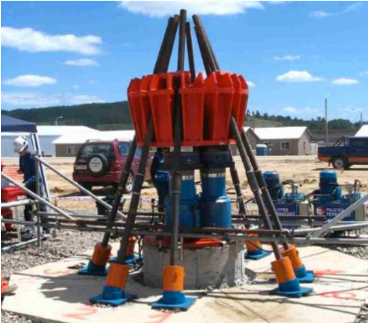
**Ilustración 27. Ensayo de carga estática de compresión axial con anclajes de reacción**
