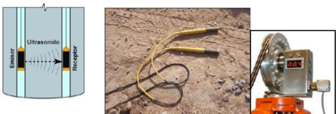
Ilustración 20. Esquema de medida y equipo utilizado
