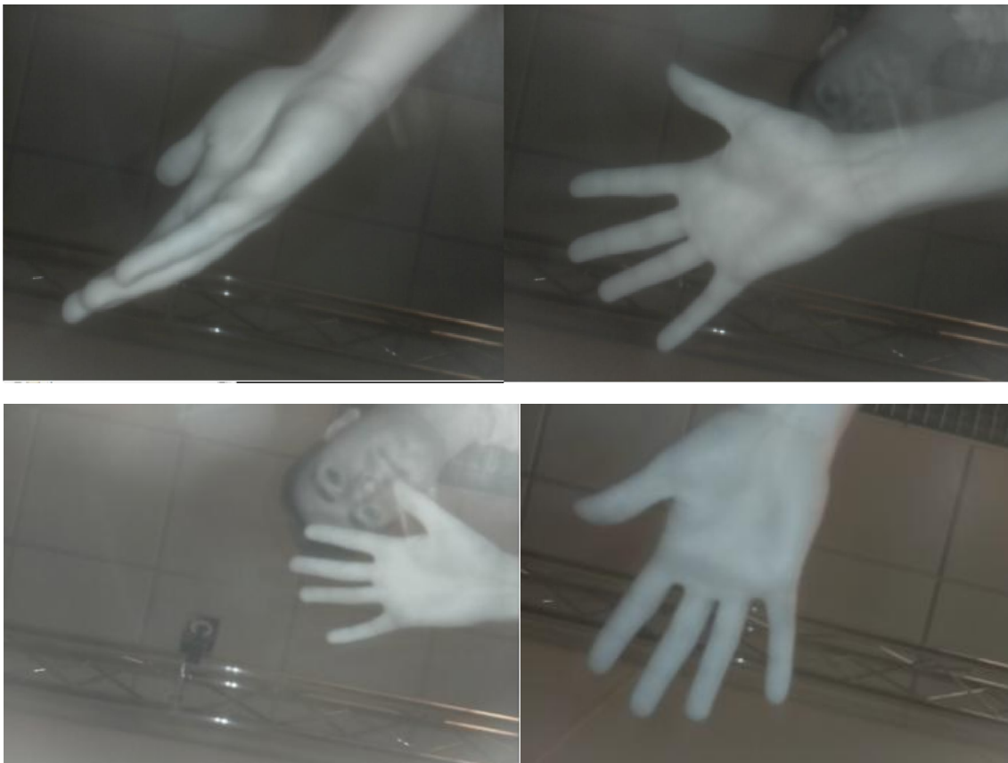
Ilustración 16. (Arriba izq.) foto de la mano deformada por estar demasiado cerca del objetivo. (Arriba dcha.) la mano mantiene sus proporciones y vemos como la persona de detrás esta menos iluminada y de forma homogénea. (Abajo Izq.) la imagen tiene brillos producidos por los elementos de la habitación. (Abajo Dcha.) imagen con condiciones óptimas.
