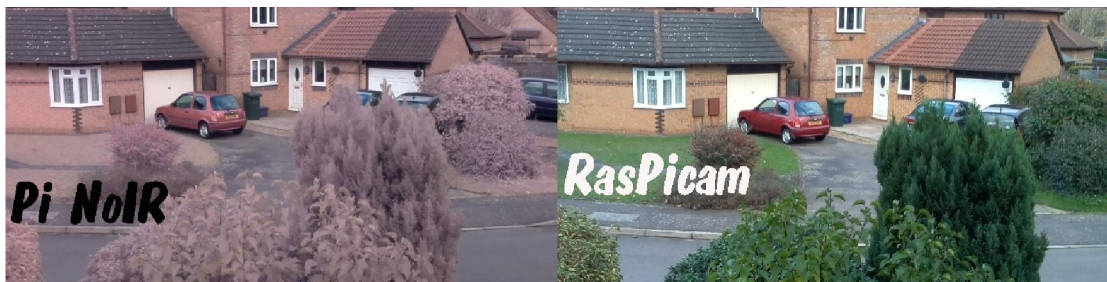
Ilustración 11. Efecto de la luz infrarroja en las fotos de la cámara Pi Noir.
