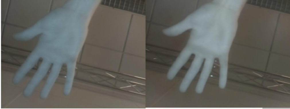
Ilustración 13. Comparación de imagen con distintas potencias de luz IR (Izq.) foto del visor con duty cycle 25%. (Dcha.) foto con duty cycle 100%.
