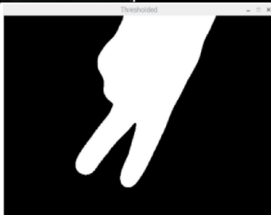
Ilustración 23. Resultados tras la conexión de la luz infrarroja para los gestos 1 y 2, con resultados satisfactorios en el reconocimiento del contorno y la detección del número de dedos.
