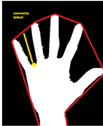
Ilustración 19. Ejemplo que muestra el contorno convexo generado y un defecto de convexidad que permite detectar el espacio entre dedos.
