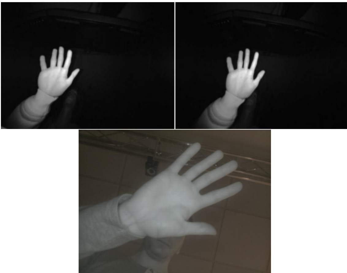
Ilustración 26. Imágenes tomadas con Leap Motion (arriba) comparada con imagen del dispositivo propio (abajo).
