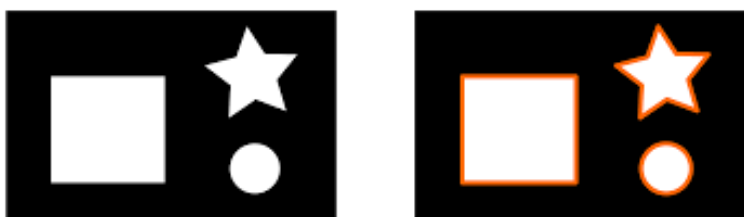
Ilustración 18. Ejemplo de imagen antes y tras la utilización de la función cv2.findcontours . Se puede ver el resultado de detección de los contornos en la imagen de la derecha.
