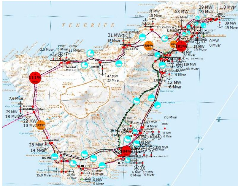
Fig. 16 Cuarta simulación: traspaso de potencia de Arona a Guía de Isora (fuente propia)
