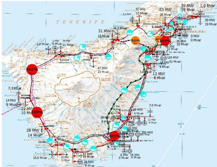
**Fig. 15 Tercera simulación: desconexión de los grupos de cogeneración (fuente propia)**
