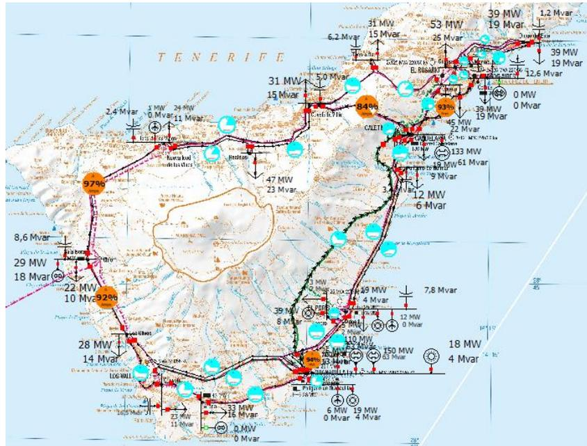
Fig. 30 Adición de la nueva generación fotovoltaica y eliminación de los grupos diésel en Granadilla (fuente propia)
