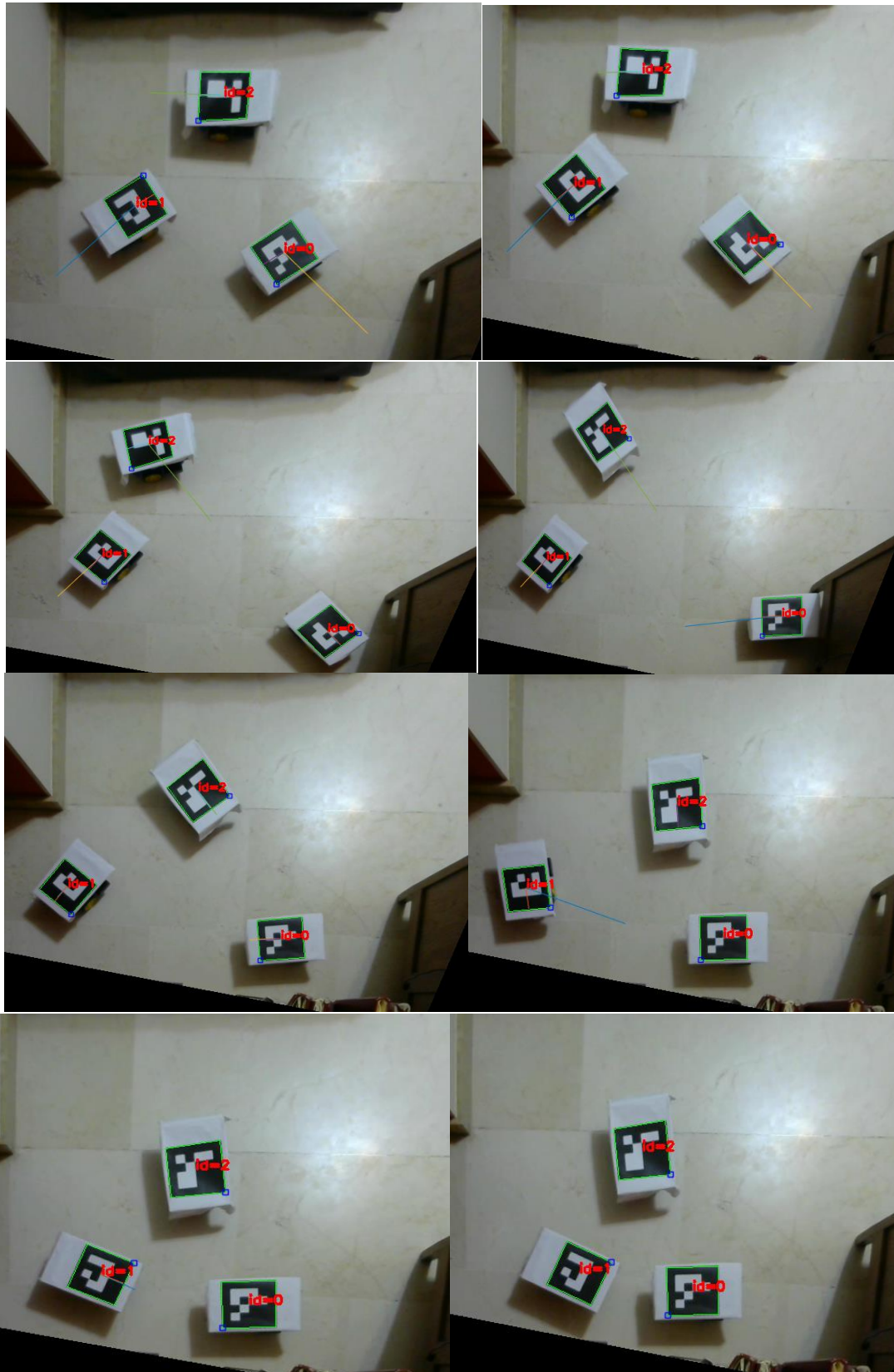
Figura 7.4 Fotografías en las que se ve distintos momentos de un control con tres robots. Se puede observar que uno de los robots es más lento que el resto debido a la diferencia de motores.
