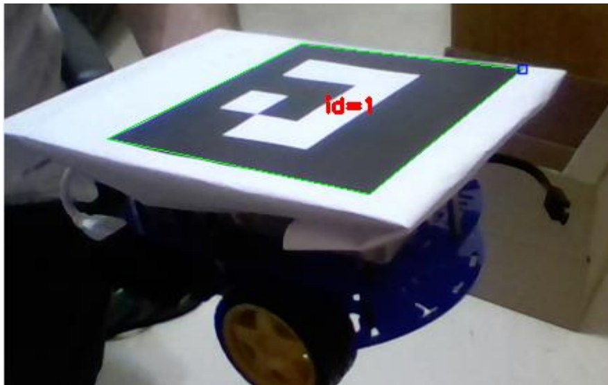
Figura IV.1 Robot con target colocado en la orientación correcta
