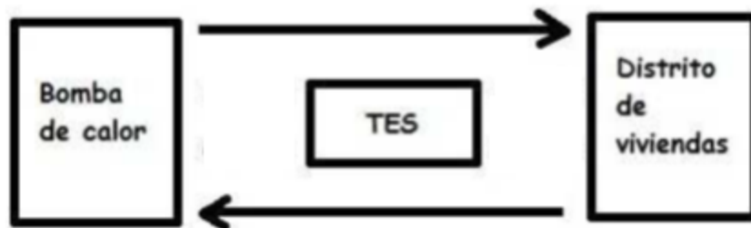
Figura 1. 5: Esquema del sistema de calefacción de distrito suministrando energía directamente al distrito.
