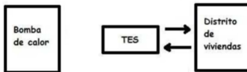
Figura 1. 9: Esquema del sistema de calefacción de distrito durante la fase de descarga del sistema de almacenamiento térmico (TES) como única fuente de energía.
