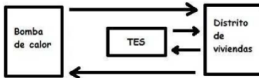
Figura 1. 8: Esquema del sistema de calefacción de distrito durante la fase de descarga del sistema de almacenamiento térmico (TES) como apoyo a la bomba de calor.
