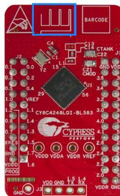
Figura 54. Antena del módulo del PSoC 4
