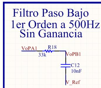
Figura 24. Filtro paso bajo de primer orden implementado en el prototipo alfa y beta
