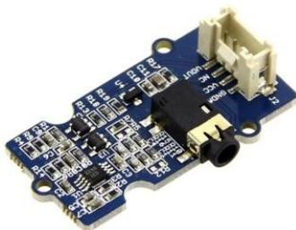
Figura 10. PCB del Grove - EMG Detector
