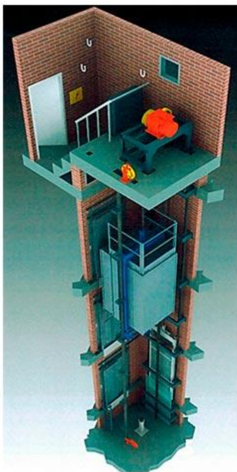
Ascensores con Cuarto de Máquina
