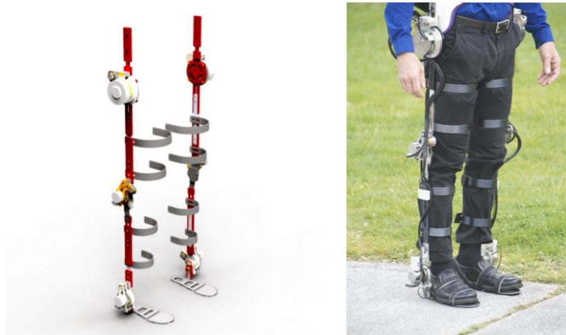
Figura 5 Exoesqueleto H1 a) Modelado 3D. b) Prototipo.
