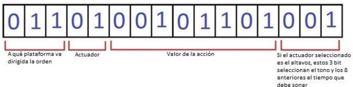
Figura 22: Estructura de la trama que sirve para enviar una orden a una plataforma.
