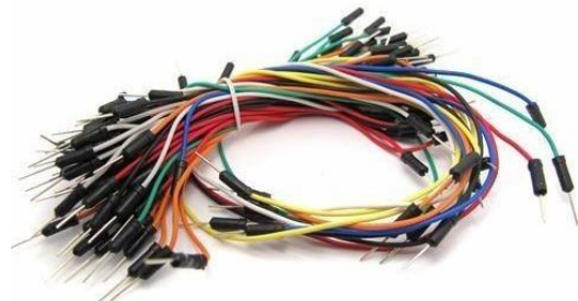
Figura 27: Cables de colores de punta dura.
