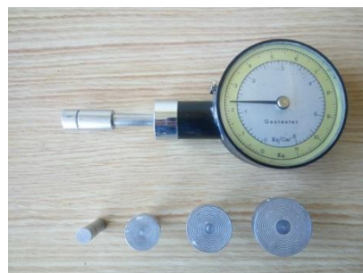
Fig. 29. Penetrómetro Geotester con el que se ha realizado el cálculo de la impedancia mecánica de las diferentes zonas de estudio.
