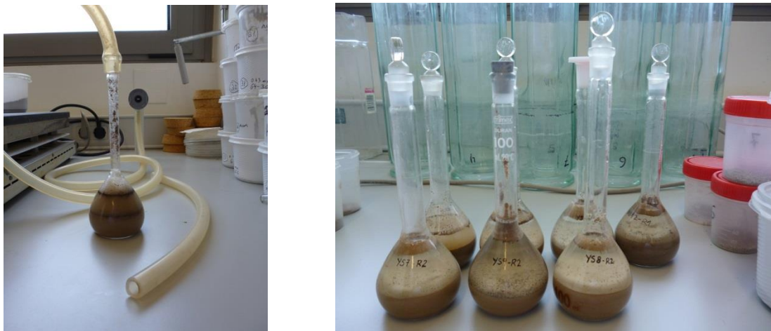
Fig. 25. Matrices aforados con tierra y etanol (derecha). Matriz aforado conectado a una bomba de vacío (izquierda)
