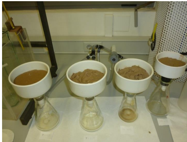
Fig. 28. Muestras en embudo Buchner filtrando al vacío.
