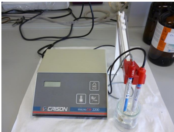
Fig. 21. De izquierda a derecha, conductímetro y pH-metro de la EPSH empleados en la determinación de la conductividad eléctrica y del pH de las muestras.
