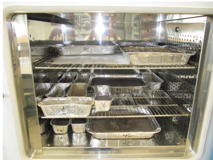
Fig.22. Estufa empleada para la cuantificación de sedimentos
