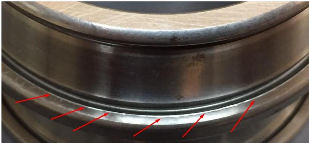
Figura 2. Ejemplo de rodamiento con error de retalón en testa.
