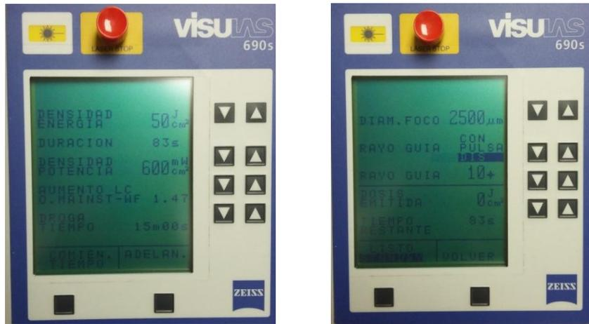
**Figura 8.** Pantalla del láser donde se puede seleccionar la densidad, energía, diámetro del foco y otros parámetros.
