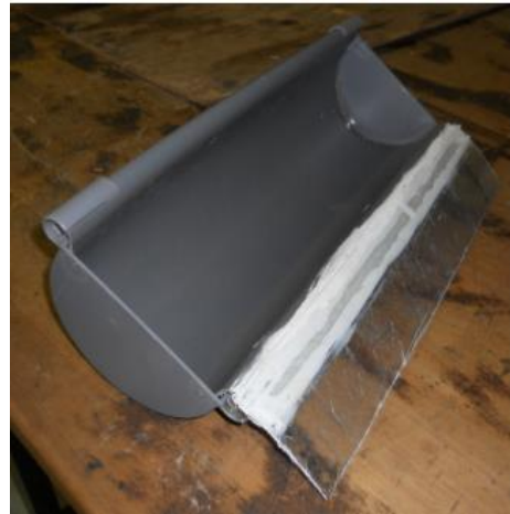
Figura 6: Trampa Gerlach formado con un tubo de PVC (canalón para recogida de agua de los tejados) y lamina de fibra de vidrio para mejorar el anclaje y la recogida de suelo y escorrentía.
