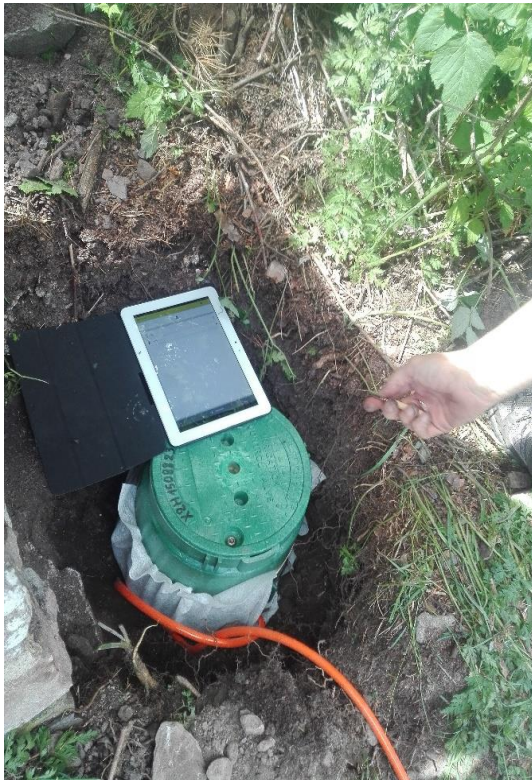
Imagen 26: a la izquierda el ordenador donde se registran los datos. A la derecha la placa que registra las pisadas de los visitantes.
