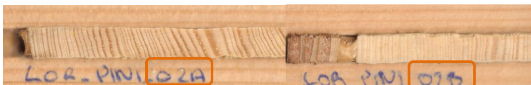
Figura 6: Señalización del árbol número 2 por medio de dos cores (core A y core B).
