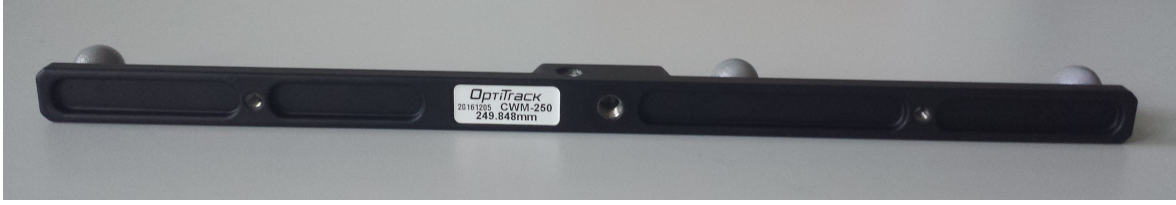
Figura B.10: Longitud con precisión sub-milimétrica de la varilla de calibración CWM-250 disponible en el laboratorio de despliegue del sistema OptiTrack.
