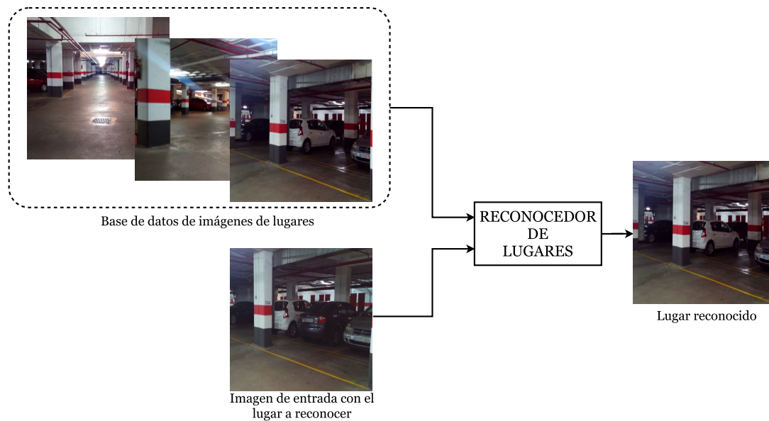
Figura 1.2: Funcionamiento como caja negra de un reconocedor de lugares. La entrada del reconocedor es la información de n lugares por un lado y la del lugar a reconocer por otro. La salida es el lugar reconocido.
