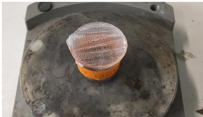
Figura 14. Muestra de cartón sometida a extracción 24 h con solución EtOH/H 2 O (3:1).
