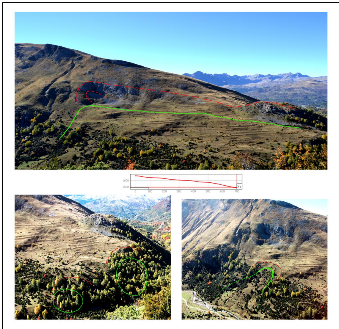
Figura 28. Deslizamiento D5. (Arriba) vista de detalle de la cicatriz representada por la línea roja discontinua en verde la masa deslizada. (Abajo) Vista del deslizamiento D5 y de los detalle de las cicatrices y cuerpos de los deslizamientos secundarios, en rojo y verde, respectivamente. Perfil longitudinal.
