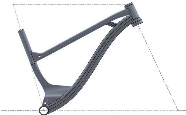
Para el diseño de cada componente, se usarán unas líneas de construcción para indicar y delimitar las medidas establecidas y así tener el diseño con la geometría elegida. Una vez modeladas las distintas partes que forman un subensamblaje, por ejemplo el triángulo delantero, se ensamblarán para comprobar que las medidas encajan adecuadamente y a continuación un análisis de interferencias para comprobar si hay piezas que se entrecrucen con otras pudiendo formar un posible error.
