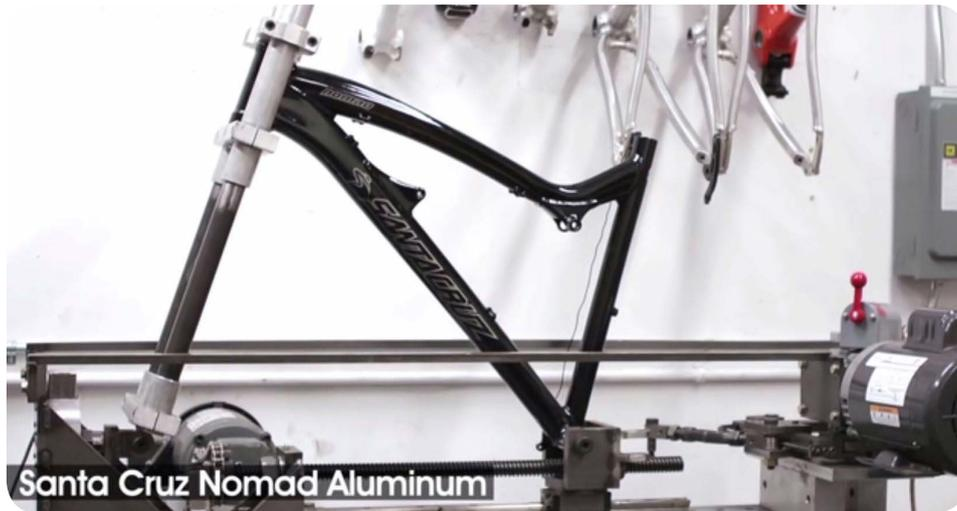
Sistema real de tornillo sin fin del ensayo.
