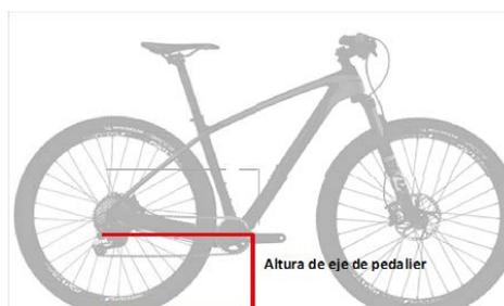
Esquema de la altura de caja de pedalier.
