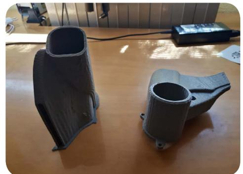
Caja de pedalier (Pieza 7, dividida en 2 partes)
