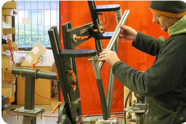
Una vez fijados los distintos componentes, se procede a soldar, hasta que el cordón de soldadura quede uniforme garantizando así la unión de las piezas. Una vez enfriado se prepara el cuadro para la posterior capa de pintura.
