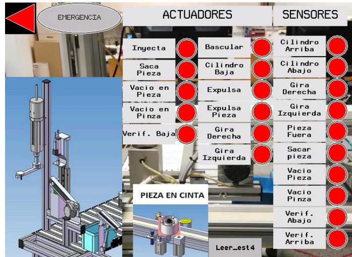
Figura 196. Pantalla Sensores y Actuadores estación 4
