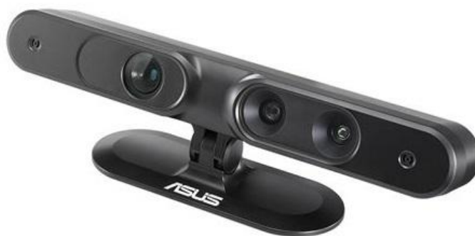
Figura 2.1. ASUS Xtion PRO LIVE. Cámara RGB-D. Pasiva. [1]
