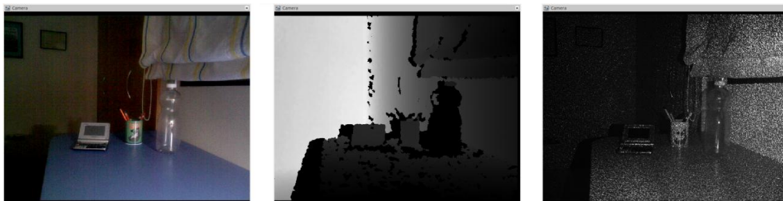
Figura 2.3. Imagen RGB-D. Imagen RGB. Imagen D. Imagen IR
