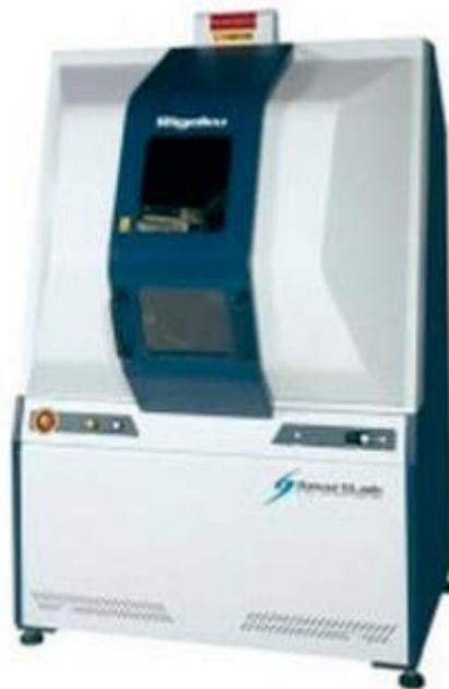
Figura 32. Difractómetro de rayos-X Max Rigaku.
