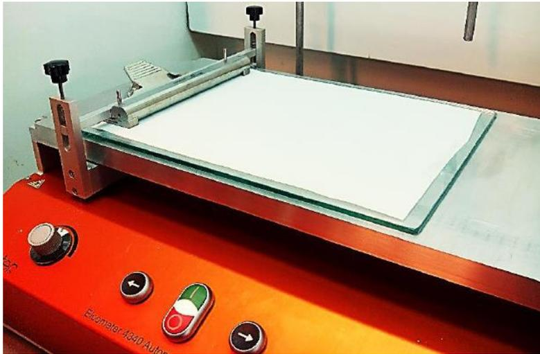
Figura 7. Equipo de Doctor Blade para la realización del casting de las membranas.
