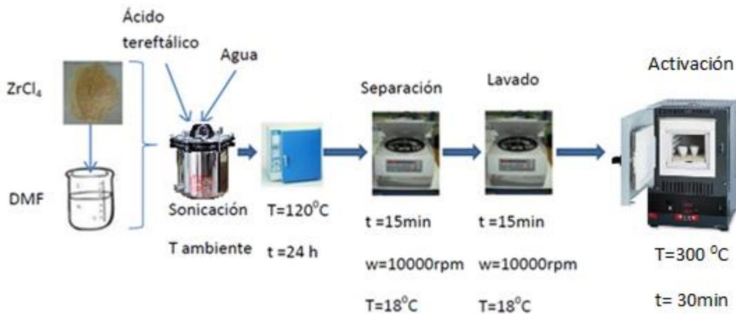
Figura 5. Esquema del proceso de síntesis de UiO-66.
