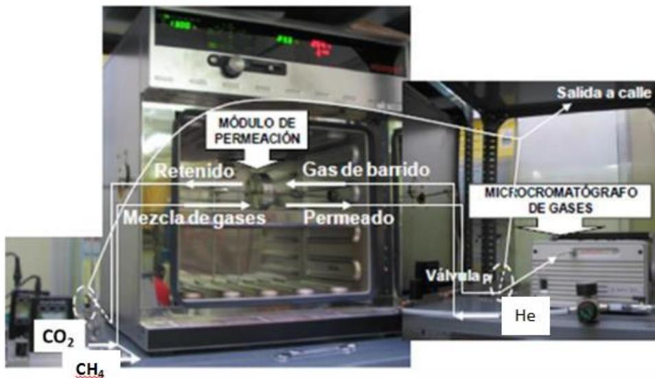
Figura 10. Esquema de la planta de permeación empleada.
