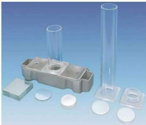
Figura 9. Diferentes columnas de sedimentación para el estudio de la comunidad planctónica mediante el método Utermöhl
