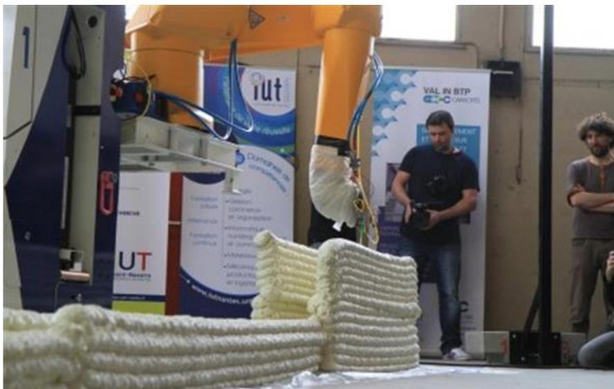
*Ilustración 87 - Impresión de espuma*
