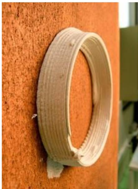
*Ilustración 24 - Impresión de anillo en paramento vertical*
