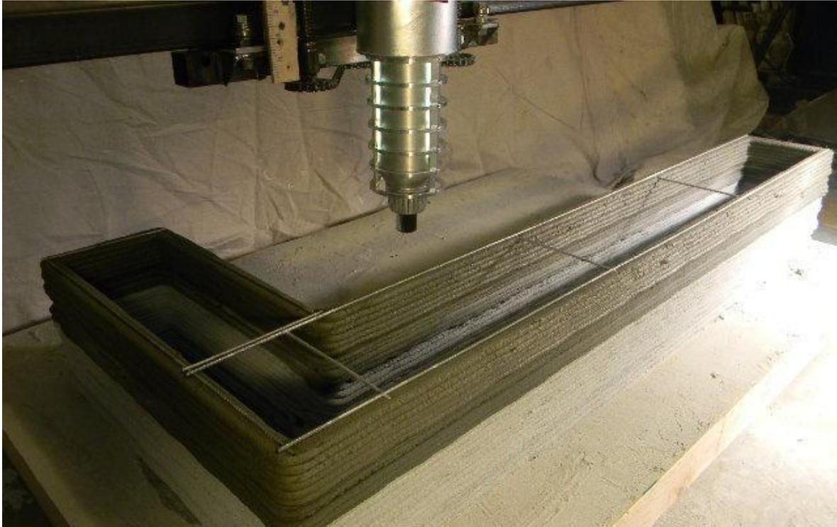
*Ilustración 19 - Armado interior*
