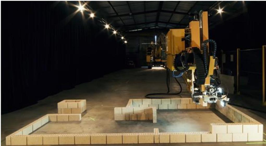
*Ilustración 57 - Máquina que sólo deposita ladrillo*
