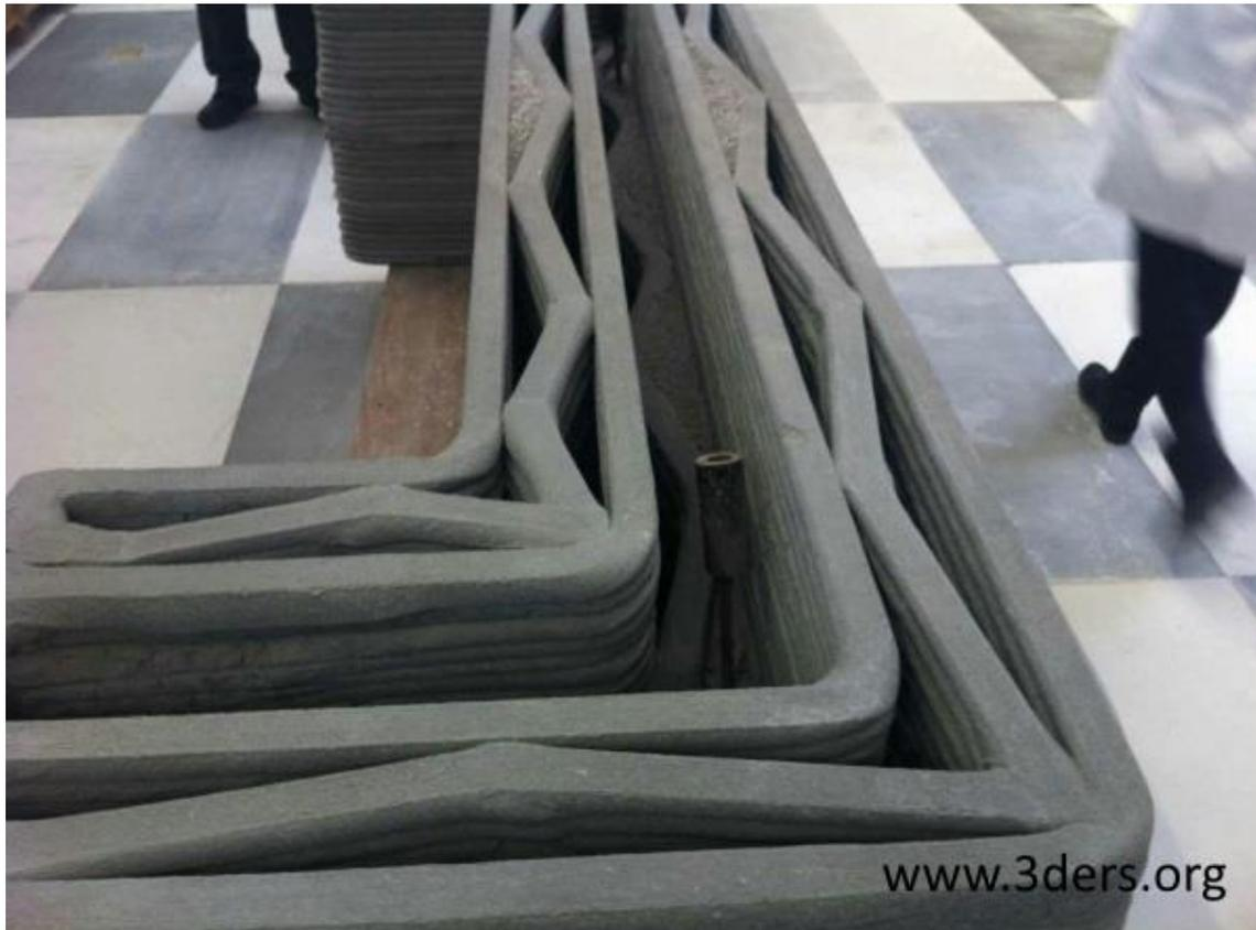
*Ilustración 29 - Ejemplo muro autoresistente*
