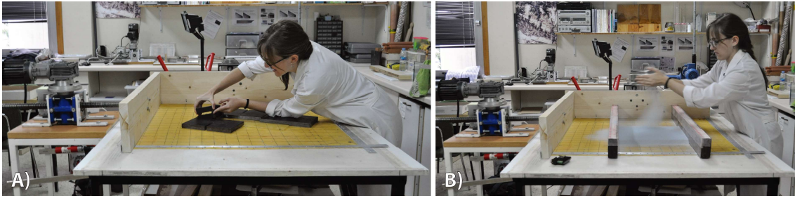
Fig. 4.- A) Preparación del confinamiento. B) Depósito de la arena mediante tamiz (Laboratorio de Modelización Analógica, área de Geodinámica Interna).
