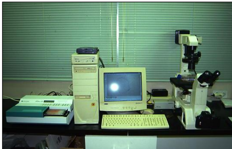
Figura 18. Sistema informático utilizado para los estudios con WST-1 y de cinética de reparación celular conectado a un microscopio de inversión de fases a través de una cámara de vídeo (derecha) y a un espectrofotómetro de microplacas (izquierda).
