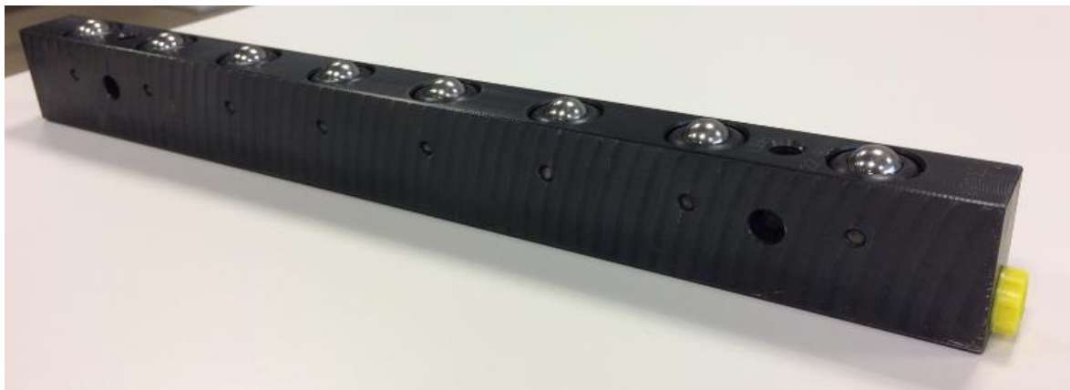
Imagen 28: Regletas hidráulicas de bolas para E102
