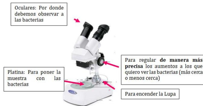
Figura 6 b: Representación de una lupa microscópica con etiquetas para entenderla.
