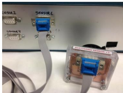
Figura 7. 35. Ejemplo del sensor de conectado al módulo a través de la conexión DB9
