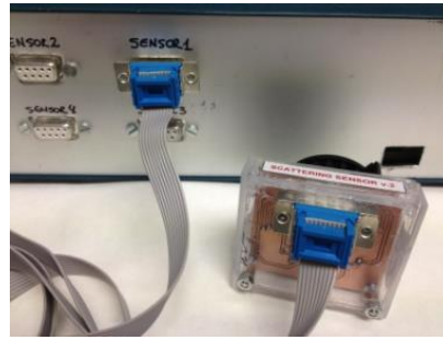
Figura 8. 29. Ejemplo del sensor de dispersión conectado al módulo a través de la conexión DB9
