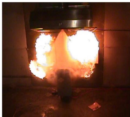
Figura 2. 19. Extinción del fuego mediante nebulización de agua
