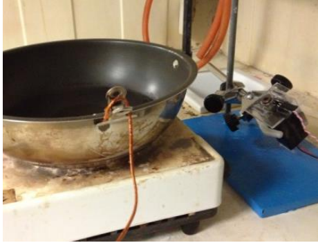
Figura 8. 52. Montaje experimental para simular la detección a distancia
