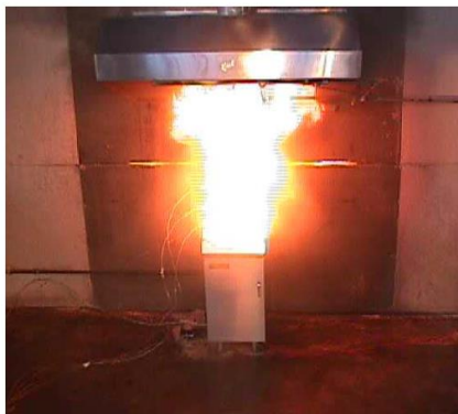
Figura 2. 18. Fuego generado por sobrecalentamiento del aceite
