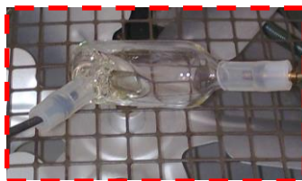
Figura 3.6. Vista interior del prototipo GC-FID con una celda de vidrio
