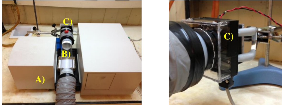
Figura 7. 7. Prototipo de cocina. A) Espectrofotómetro; B) celda de cuarzo; C) sensor
