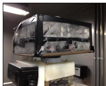
Figura 8. 46. Condensación de agua sobre el multisensor
