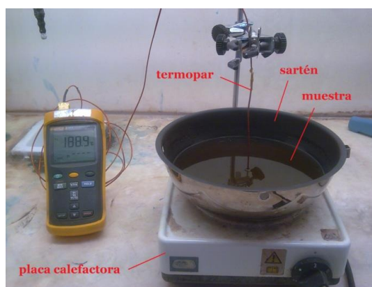
Figura 3.1 Montaje para la determinación del punto de humo visual. 200g de muestra de aceite
