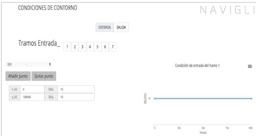
Figura I. Condición de contorno en la entrada 1. Igual en las demás entradas.
