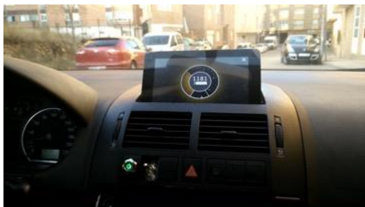
Figura 16 – Parte OBD en funcionamiento (RPM)
