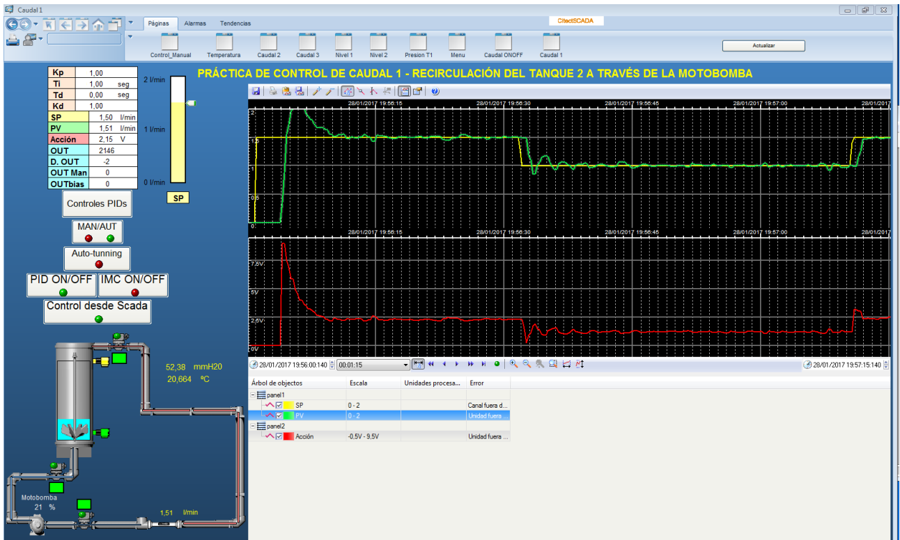
Figura 34. Pantalla SCADA de Control tipo 1 de Caudal con PID
