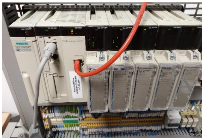
Figura 2. Imagen del PLC TSX-Premium P57 2634M
