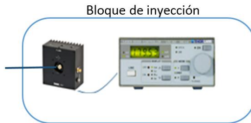
Figura 3. 10 Bloque de inyección para medir perfiles radiales.
