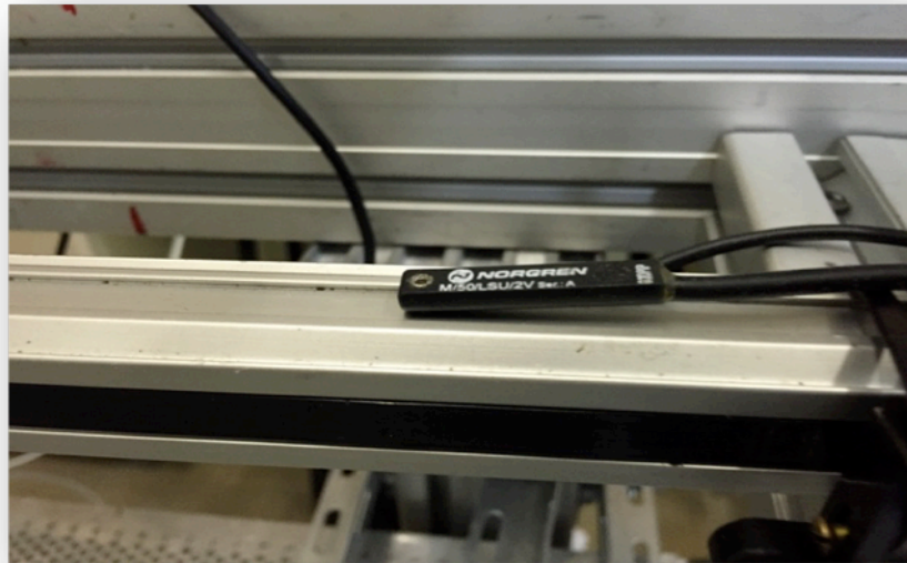
Ilustración 6: Detalle sensor proximidad magnético(Z), colocado en el final de carrera actuador.
