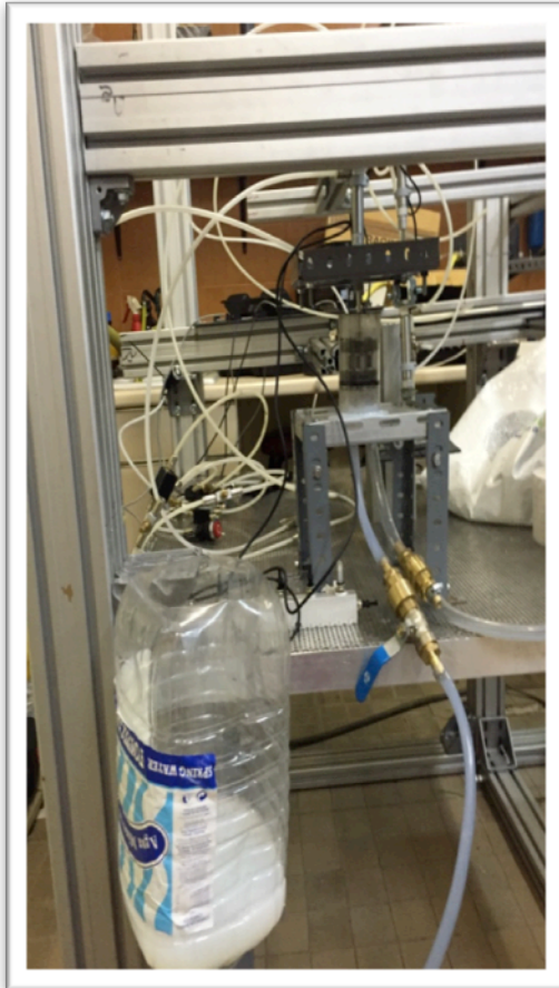
Ilustración 9: Estacion 2, depósito de agua que alimenta a la bomba casera movido por un actuador neumático.
