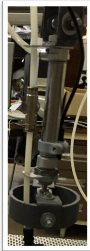
Ilustración 15.: Detalle uniones actuadores en almacén de tapones.
