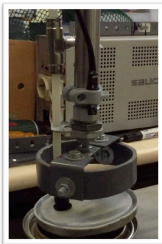
Ilustración 22, detalle actuador justo antes de soltar tapa y presionar la a contra el recipiente
