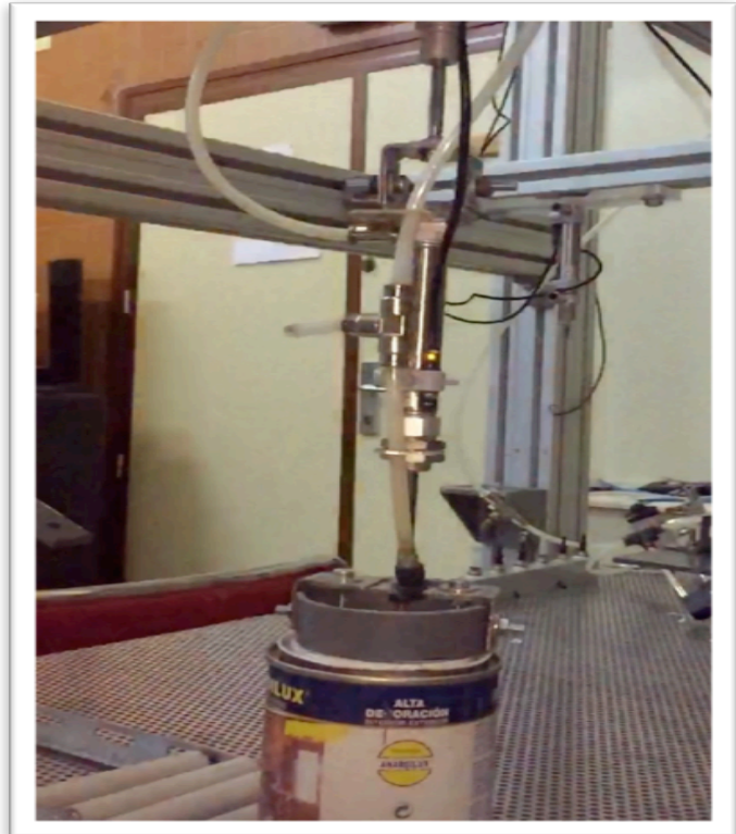
Ilustración 21, detalle sensor proximidad magnético XA, activado led naranja. Actuador presiona tapa.
