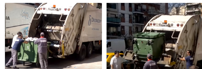
Fig. 5 y 6 Sistema de recogida carga trasera [4]
