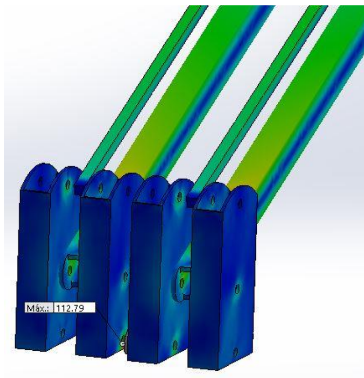
Fig 199. Reparto de tensiones en la estructura
