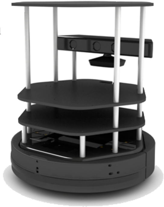
Figura 3: robot TurtleBot2 con plataformas.
